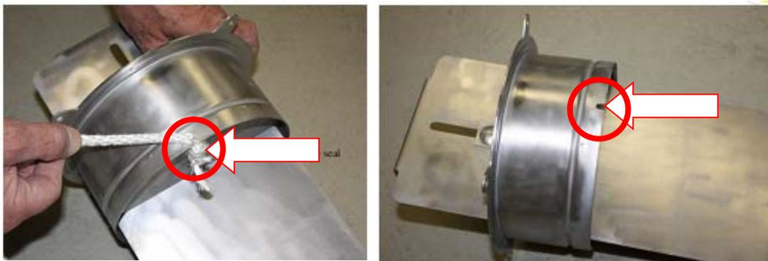
2.2. Установите задвижку в предварительно смонтированный дополнительный тройник. Пластина задвижки должна иметь уклон, чтобы обеспечить стекание конденсата в сборник конденсата.
